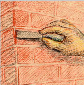
Im Sturz und Laibungsbereich der Gebäudeöffnungen können Laibungsplatten verwendet werden. Abschließende Verspachtelung der Stoßkanten mit entsprechender Streichmasse
