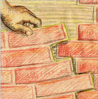
Anschließend die Platten flucht- und lotgerecht sowie mittels Montageverzahnung Stoß an Stoß auf die Klebefläche fest und gleichmäßig andrücken.
